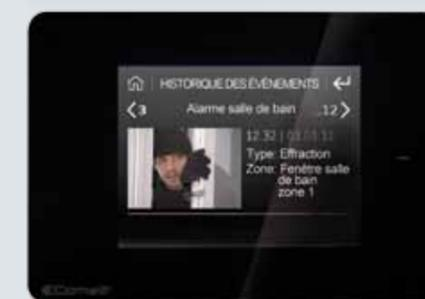
Condition d'alarme avec possibilité de sélectionner une caméra filmant en direct
